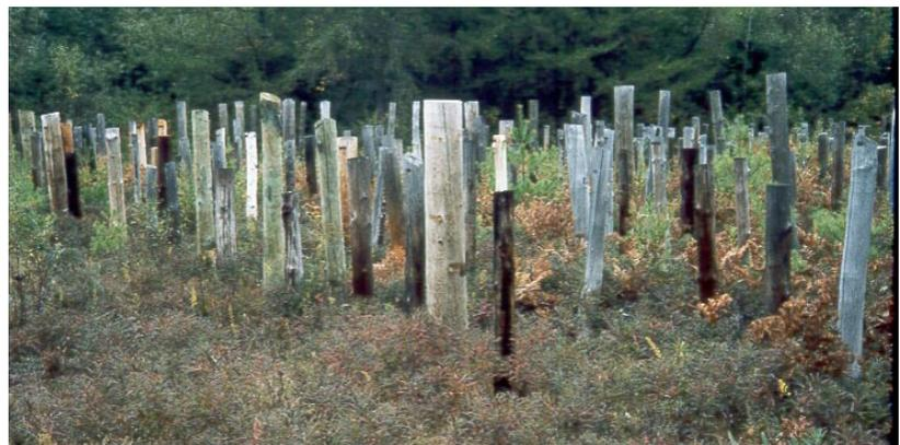
Essais de poteaux de clôture réalisés par Forintek à Petawawa (ON)
